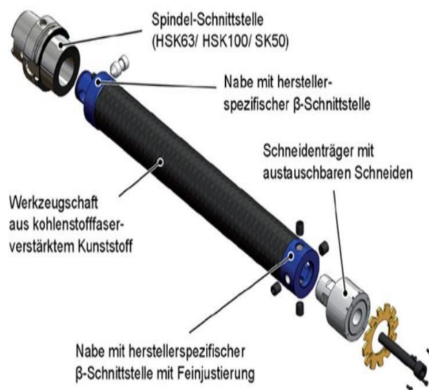
Figura 4. Construção modular de ferramenta de alargador composto. Extraído de https://www.addcomposites.com/ .
