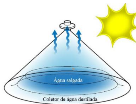
Figura 9. Diagrama esquemático de uma unidade de destilação solar. Extraído da referência 8.
