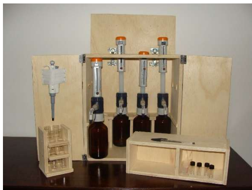
Figura 4. Kit Colorimétrico para detecção de metanol em etanol. Extraído da Referência 1.
