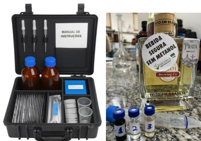
Figura 03. Kit de análise colorimétrica para detecção de metanol em bebidas, exibido com a "Cachaça 5 Madeiras Brasileiras" da Ghesti Brewing Co., produto que obteve resultado negativo para o contaminante. Fonte: Autoral.
