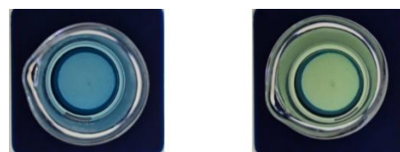
Figura 7. Solução de THC a 1% (m/v) imediatamente após a adição do reagente e após 10 minutos de reação, respectivamente. Imagem feita pelo autor.
