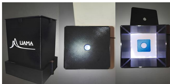
Figura 4. Câmara fotográfica utilizada para aquisição das imagens, apresentada nas vistas frontal, superior e interna. Imagem feita pelo autor.
