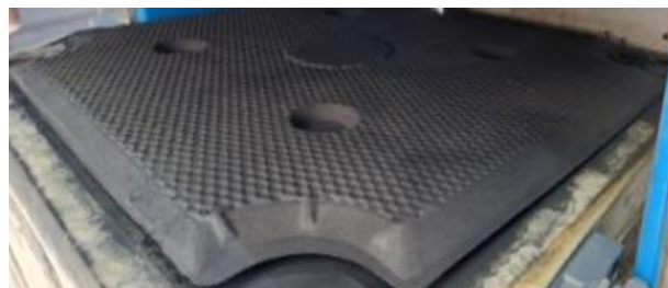
Figura 3. Resíduo sólido (torta) retirado do filtro prensa. Extraído da referência 2.
