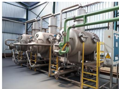
Figura 2. Funcionamento evaporador de três efeitos. Extraído da referência 2.
